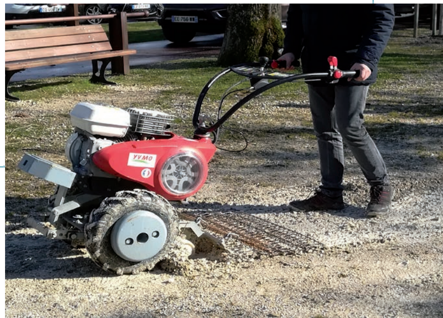
Herse mécanique en démonstration à Saint-Paul
